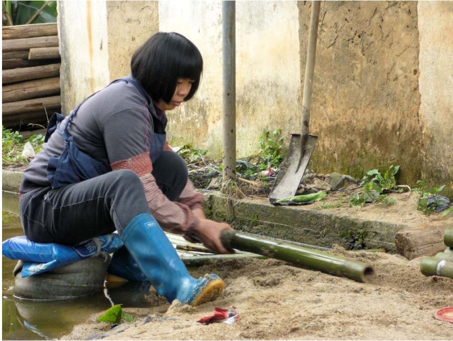
Fig. 10 Bortslipning av det naturliga vaxlagret med sand och vatten
